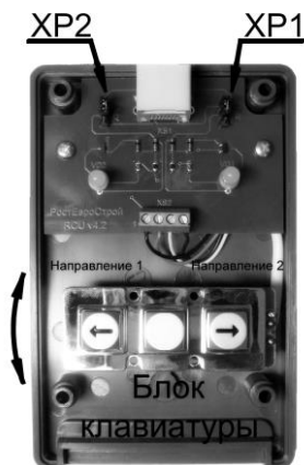
Вид пульта со снятой крышкой
